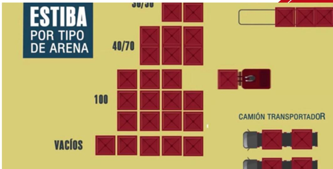
Un Manipulador de 30 tn (instalado en la locación), será el responsable de su movimiento, el cual los colocará en una plataforma autorportable con una velocidad de hasta 3 minutos por box (por carga y descarga). Esta plataforma procederá a la descarga por desnivel de manera automatizada y será controlada por un operador quien también manejará el caudal, que requiera el equipo.
